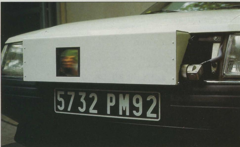
Ce prototype de télémètre à infrarouge développé par Renault est placé à l'avant de la voiture. Il détecte des obstacles situés à plus de 300 m de distance.
