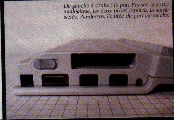
De gauche à droite : le port Phaser, la sortie analogique, les deux prises joystick, la sortie stéréo. Au-dessus, l'entrée du port cartouche.
