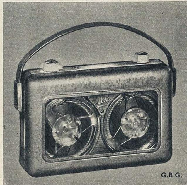
● Le magnétophone à transistors fonctionnant sur piles en éléments rechargeables est un appareil autonome portatif. On voit ici un modèle à circuit imprimé avec bobines de 9 cm assurant 1 heure d'enregistrement. Télécommande par le microphone.
