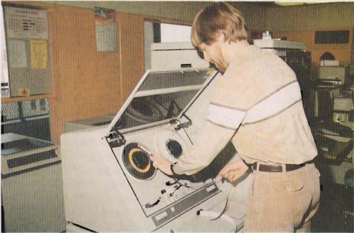
Opération de chargement d'une bande magnétique dans un dérouleur.
