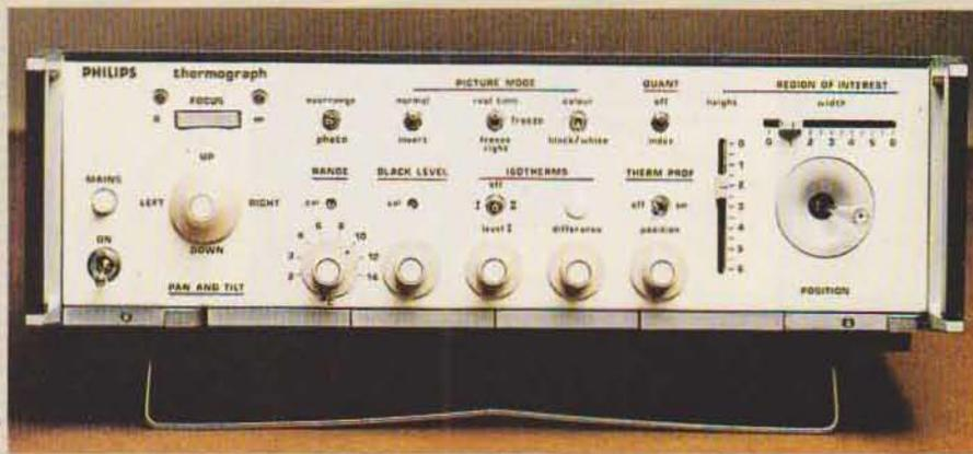
Tableau de commande et de contrôle d'un thermographe à image digitalisée. A droite : manettes de positionnement et curseurs de délimitation du champ d'observation.
