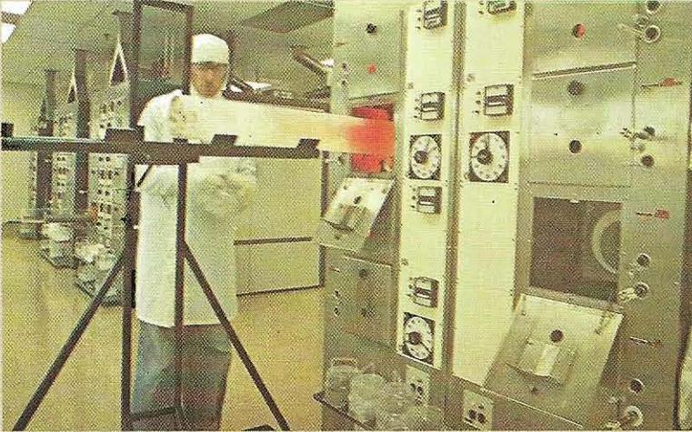
On additionne des impuretés au silicium très pur en fusion afin de lui conférer les propriétés électriques désirées. Les atomes de silicium viennent ensuite se ranger autour d'un minuscule noyau, donnant naissance à un monocristal presque parfait de silicium semi-conducteur.
