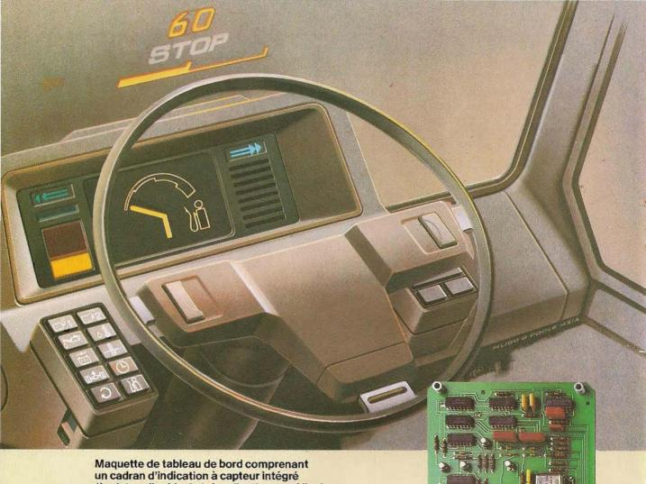
(à cristaux liquides) et visualisation parréflexion: les données apparaissent sur le pare-brise. A droite : vue intérieure de l'ordinateur de bord.
